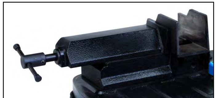
Figura 7 – Vite di regolazione della morsa.
