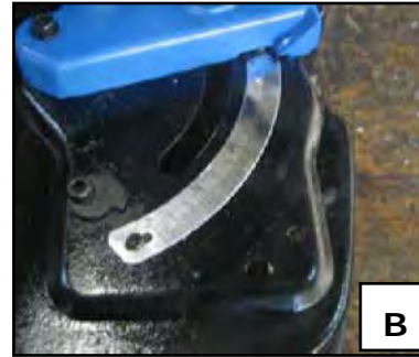
Figura 6 – Leva di bloccaggio della testa.
