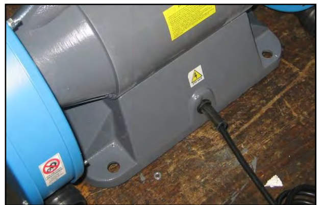
Figura 4 – Dettaglio fori di fissaggio.
