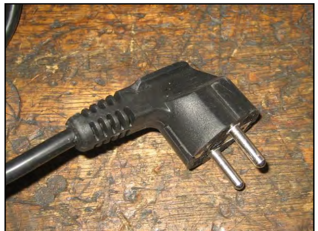
Figura 9 – Particolare spina di alimentazione.
