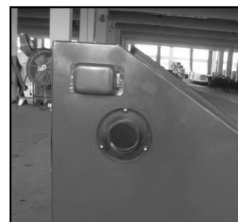
Figura 13 - Attacco al sistema di aspirazione
