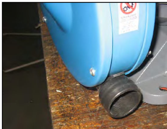
Figura 8 – Presa per il sistema di aspirazione sul riparo.
