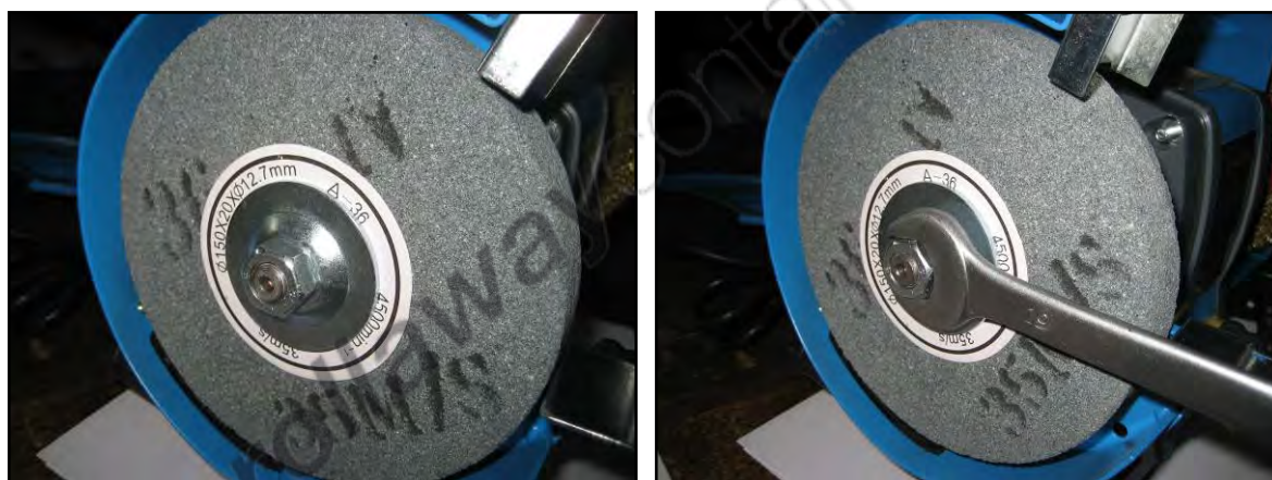
Figura 15 – Dado e flangia di fissaggio della mola.
