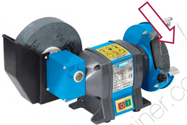
Figura 5 – Dettaglio schermi di protezione.
