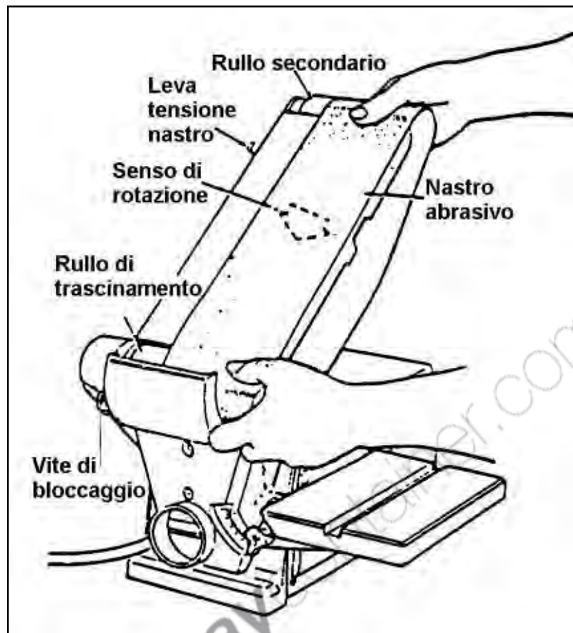
Figura 13 – Montaggio del nastro abrasivo.
