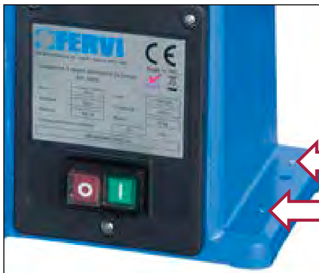
Figura 10 – Dettaglio fori di fissaggio.
