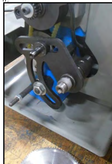
Figura 24 – Rimozione delle ruote dentate.
