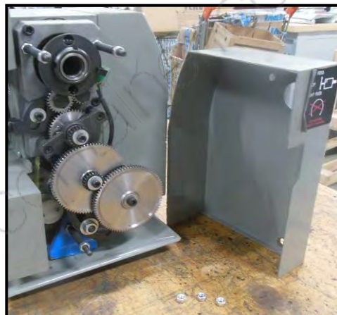
Figura 23 – Rimozione del carter di protezione.
