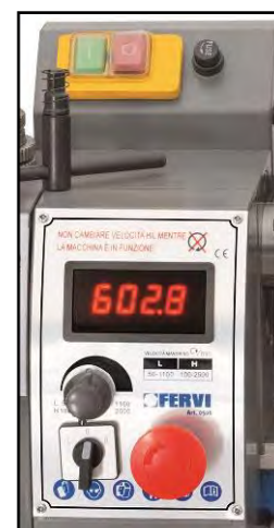
Figura 7 – Quadro elettrico e di comando
