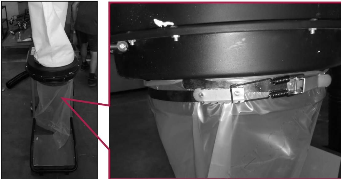
Figura 10 – Montaggio dei supporti e del corpo convogliatore.
