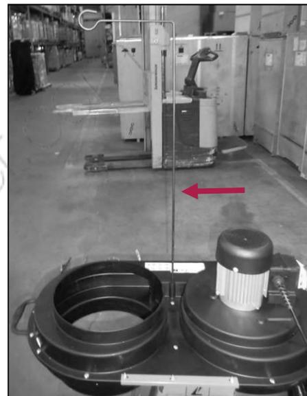
Figura 8 - Sostegno sacco filtrante.
