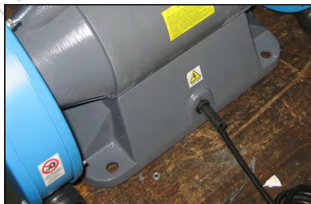
Figura 4 – Dettaglio foro di fissaggio
