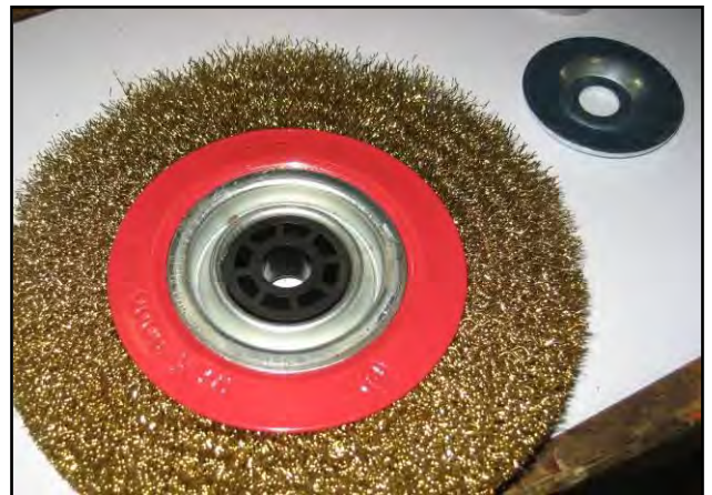
Figura 20 – Anello di riduzione in plastica.
