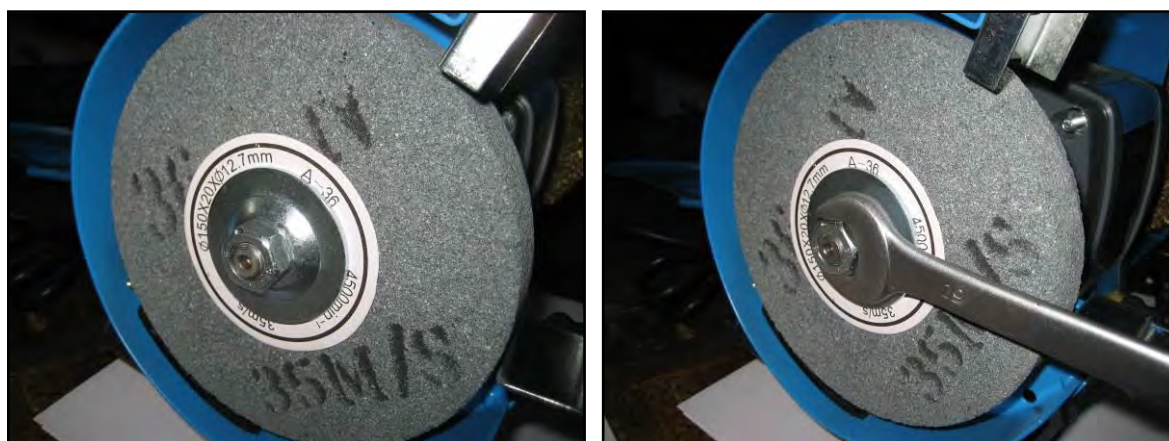
Figura 18 - Dado e flangia di fissaggio della mola.
