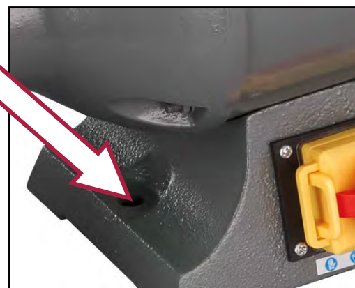
Figura 4 – Dettaglio foro di fissaggio
