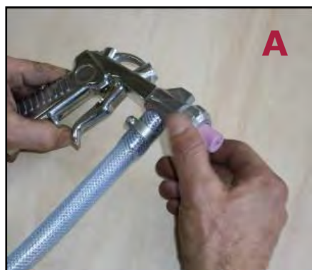
Figura 23 - Smontaggio dell'ugello della pistola sabbiatrice.
