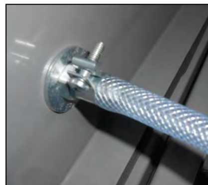
Figura 14 - Collegamento della pistola sabbiatrica
