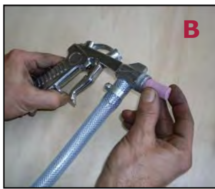
Figura 23 - Smontaggio dell'ugello della pistola sabbiatrice.
