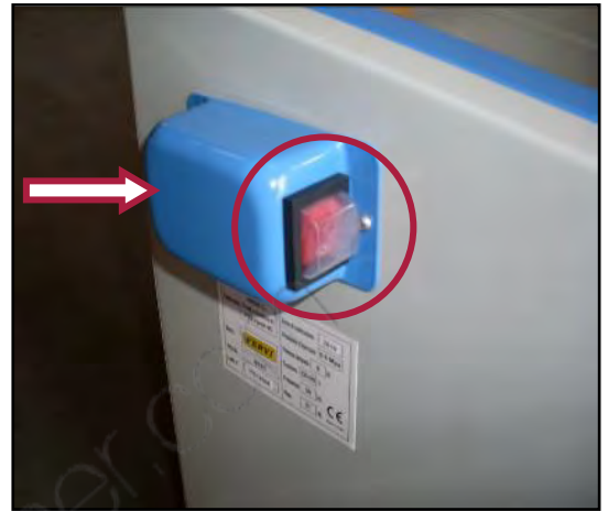
Figura 17 - Dettaglio interruttore e presa per spinotto.
