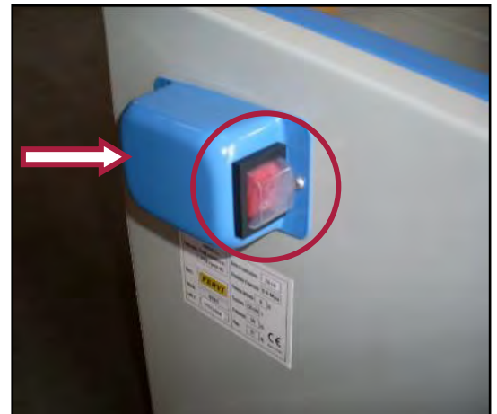
Figura 26 - Dettaglio interruttore e presa per spinotto.
