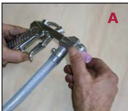
Figura 31 - Smontaggio dell'ugello della pistola sabbiatrice.
