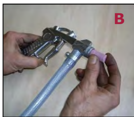
Figura 12 - Smontaggio dell'ugello della pistola sabbiatrice.
