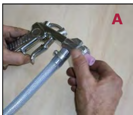
Figura 12 - Smontaggio dell'ugello della pistola sabbiatrice.
