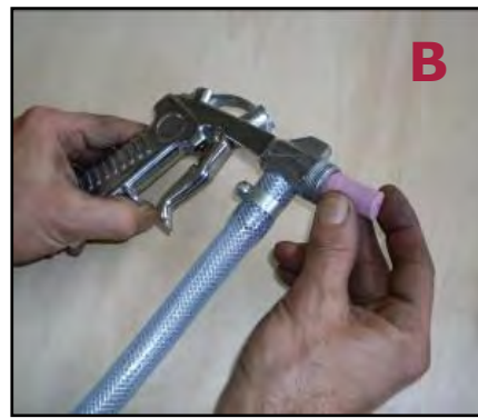
Figura 17 - Smontaggio dell'ugello della pistola sabbiatrice.
