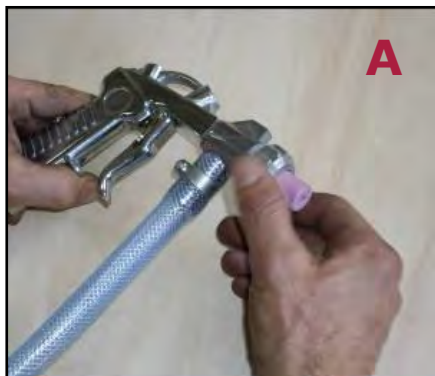
Figura 17 - Smontaggio dell'ugello della pistola sabbiatrice.
