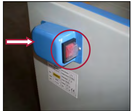
Figura 13 - Dettaglio interruttore e presa per spinotto.
