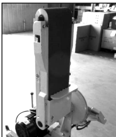
Figura 23 – Portare il nastro in verticale.
