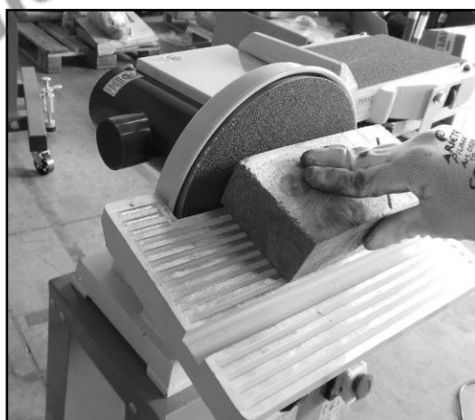
Figura 20 – Levigatura di superfici inclinate.
