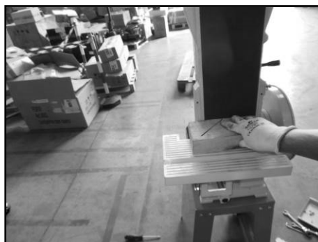
Figura 26 – Levigatura di testa con nastro verticale
