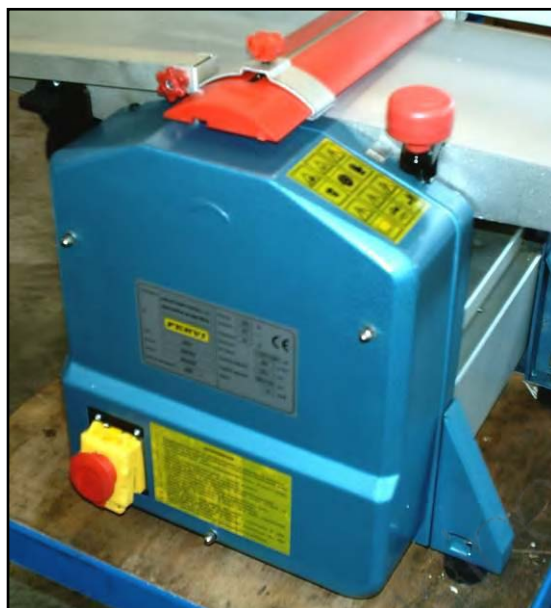
Figura 9 – Carter di protezione anteriore.
