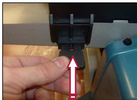
Figura 19 - Inserimento degli innesti a baionetta.
