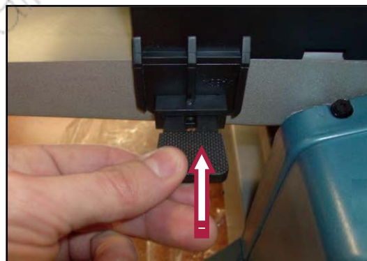
Figura 26 – Inserimento innesti a baionetta.
