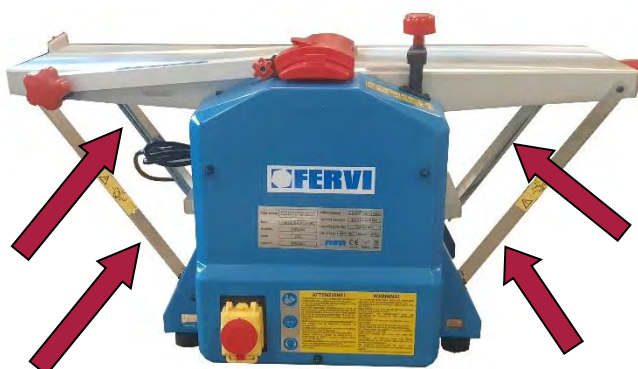
Figura 14 Rimozione staffe di trasporto.
