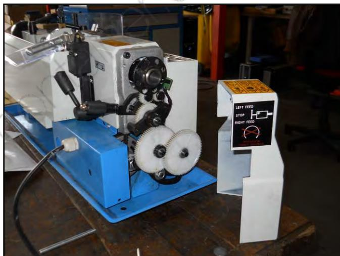
Figura 25 – Rimozione del carter di protezione.
