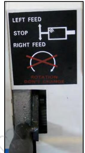
Figura 24 – Dettaglio leva.
