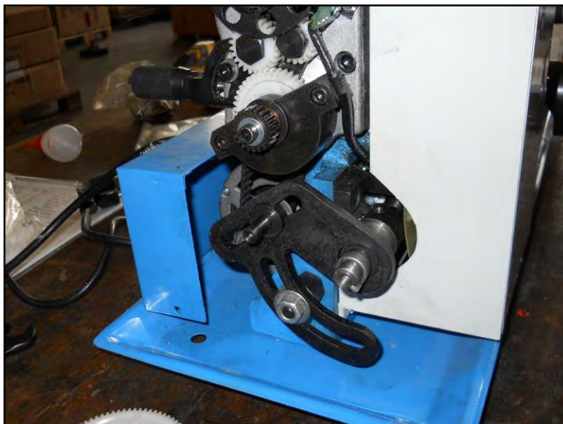
Figura 26 – Rimozione delle ruote dentate.
