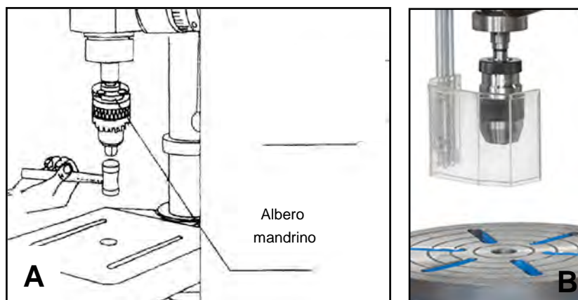
Figura 2 - mandrino (A: battere col martello – B: vista d'insieme).
