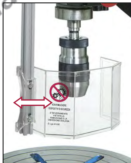
Figura 21 - Scorrimento del riparo in senso longitudinale
