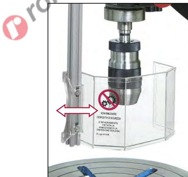
Figura 9 - Scorrimento del riparo in senso longitudinale
