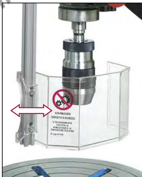
Figura 9 - Scorrimento del riparo in senso longitudinale
