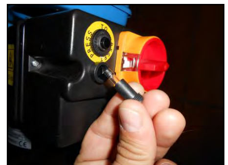
Figura 19 – Fusibile di protezione.
