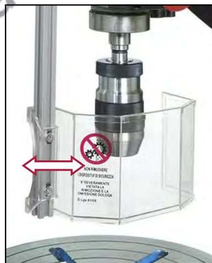
Figura 21 - Scorrimento del riparo in senso longitudinale
