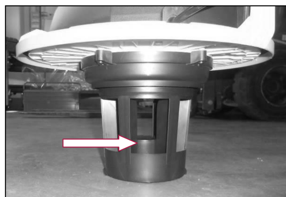
Figura 10 – Galleggiante di sicurezza.
