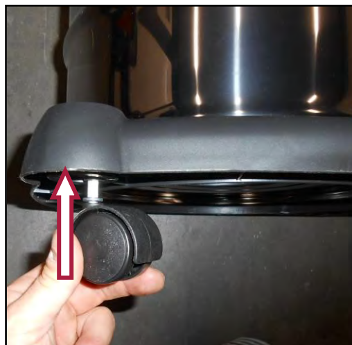
Figura 6 – Montaggio ruote pivotanti anteriori.
