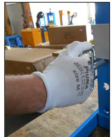
Figura 21 – Estrazione del perno di supporto.
