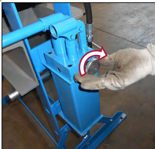
Figura 23 – -Chiusura valvola di scarico.
