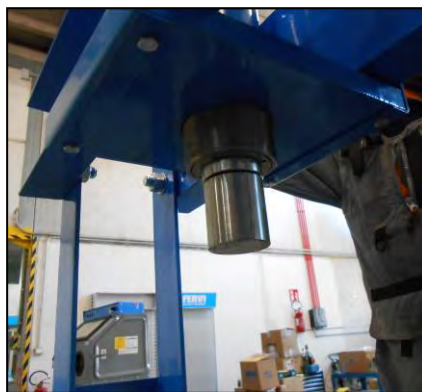
Figura 16 – Montaggio del pistone idraulico.
