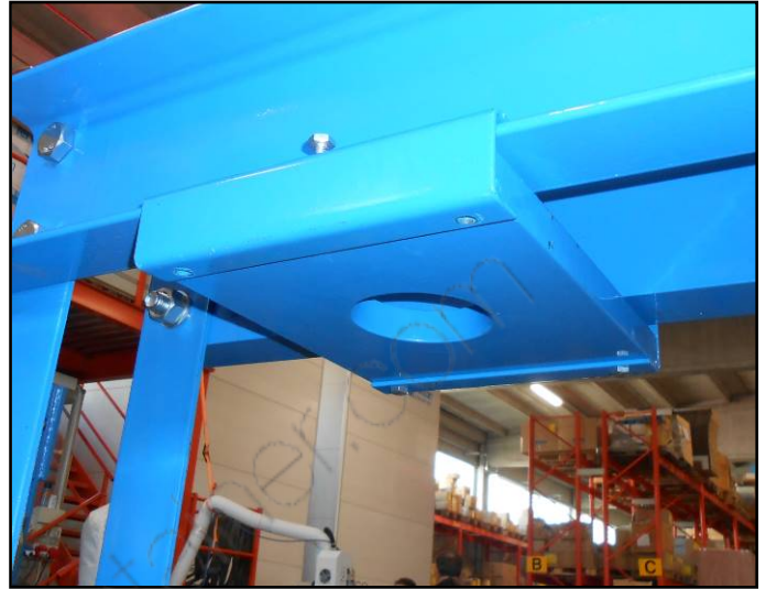
Figura 15 – Montaggio della piastra di supporto del cilindro idraulico.
