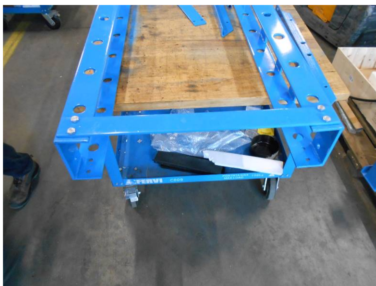
Figura 10 – Montaggio delle traverse inferiori.
