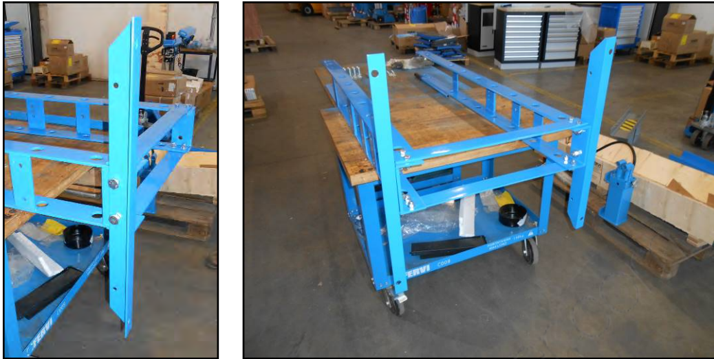
Figura 11 – Montaggio dei piedi di sostegno / traverse inferiori e piedi di sostegno montati.
