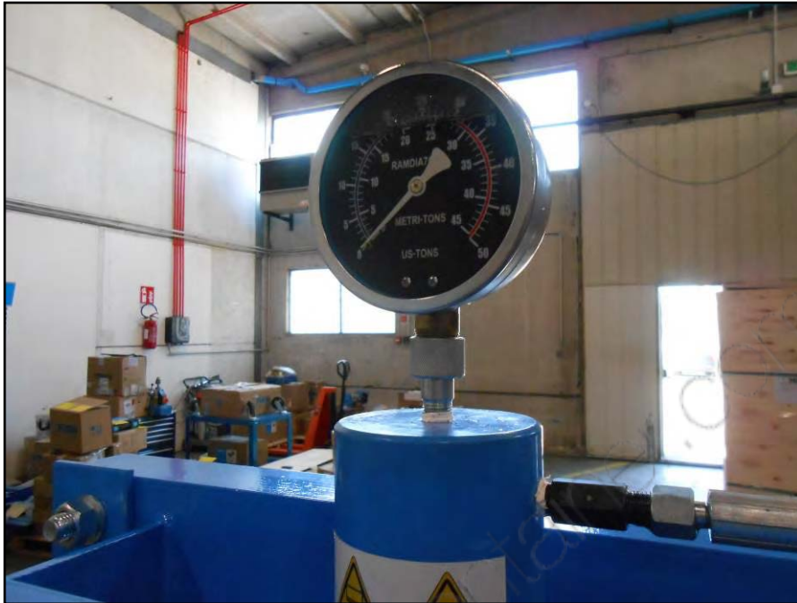
Figura 19 – Montaggio del manometro
