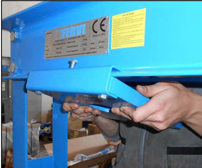
Figura 15 – Montaggio della piastra di supporto del cilindro idraulico.
