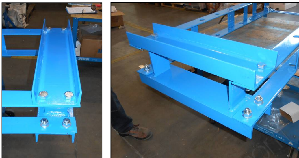
Figura 13 – Montaggio della traversa superiore.
