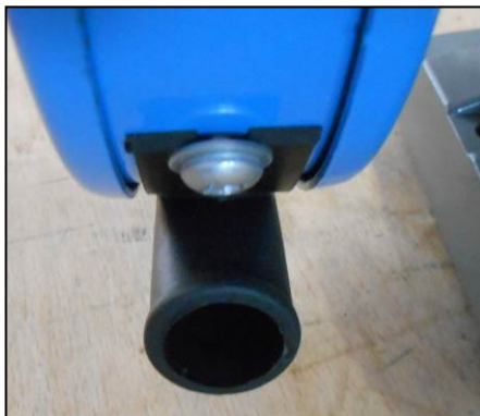
Figura 8 – Presa per il sistema di aspirazione sul riparo.
