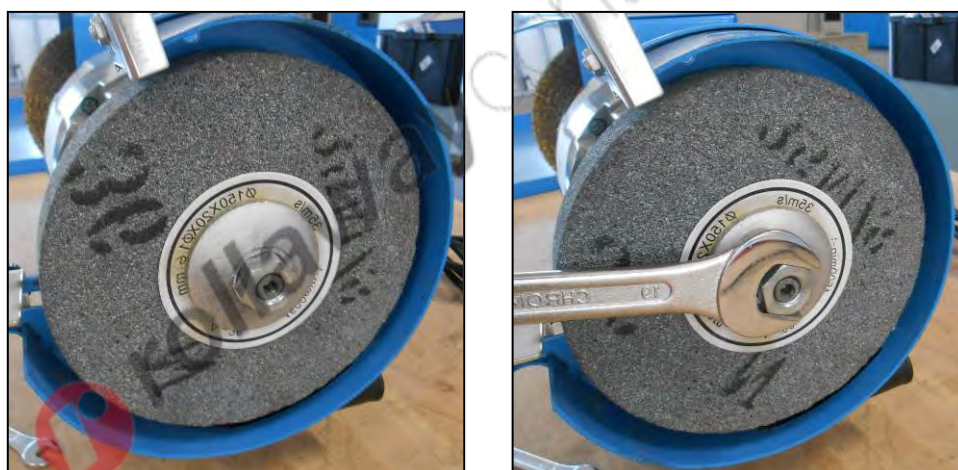
Figura 15 – Dado e flangia di fissaggio della mola.
