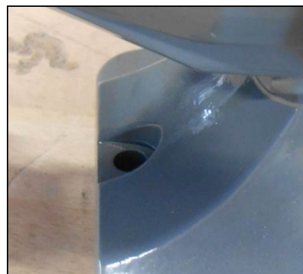
Figura 4 – Dettaglio foro di fissaggio
