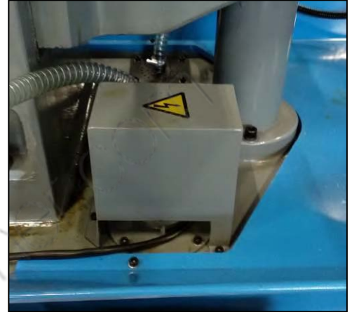
Figura 18 - Motore elettrico della pompa di refrigerazione.
