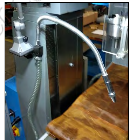
Figura 21 - Rubinetto di uscita del fluido refrigerante.
