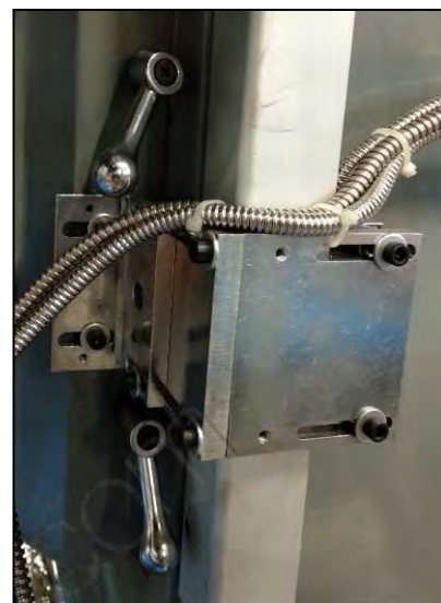
Figura 27 – Leve di bloccaggio della movimentazione verticale della tavola.
