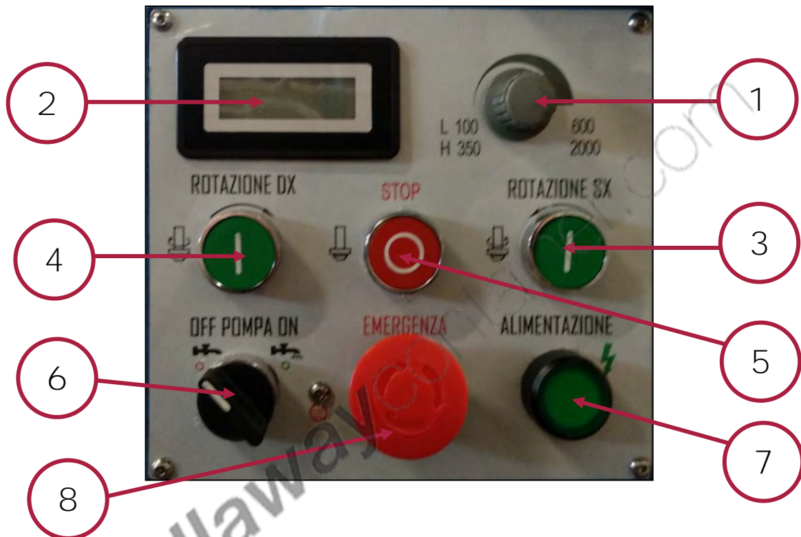
Figura 7 – Quadro di comando della macchina.
