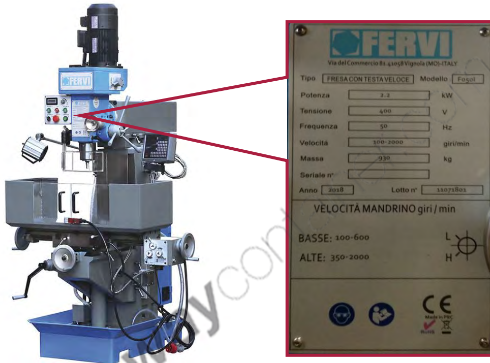
Figura 3 – Targa di indicazione della velocità di rotazione del mandrino.
