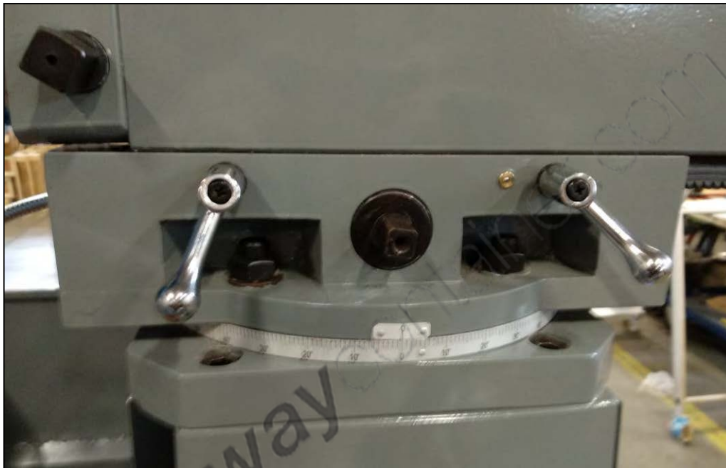
Figura 17 – Viti di fissaggio della testa.
