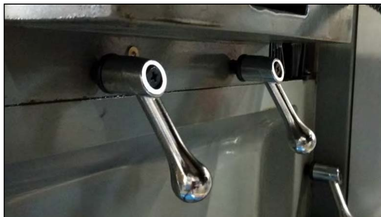
Figura 37 – Leve di bloccaggio della movimentazione radiale della tavola.
