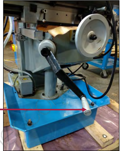
Figura 15 - Leva per la movimentazione verticale della tavola.
