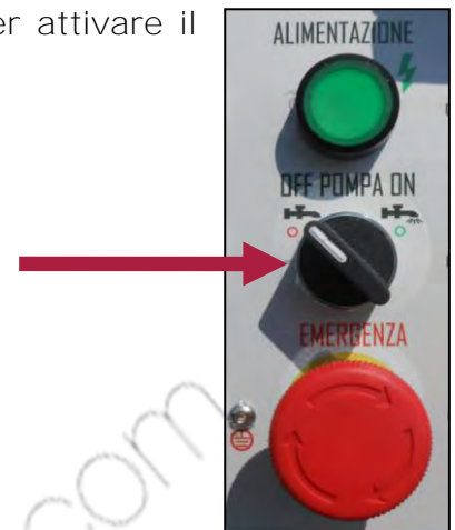
Figura 23 - Selettore per l'attivazione della pompa di aspirazione del liquido refrigerante.
