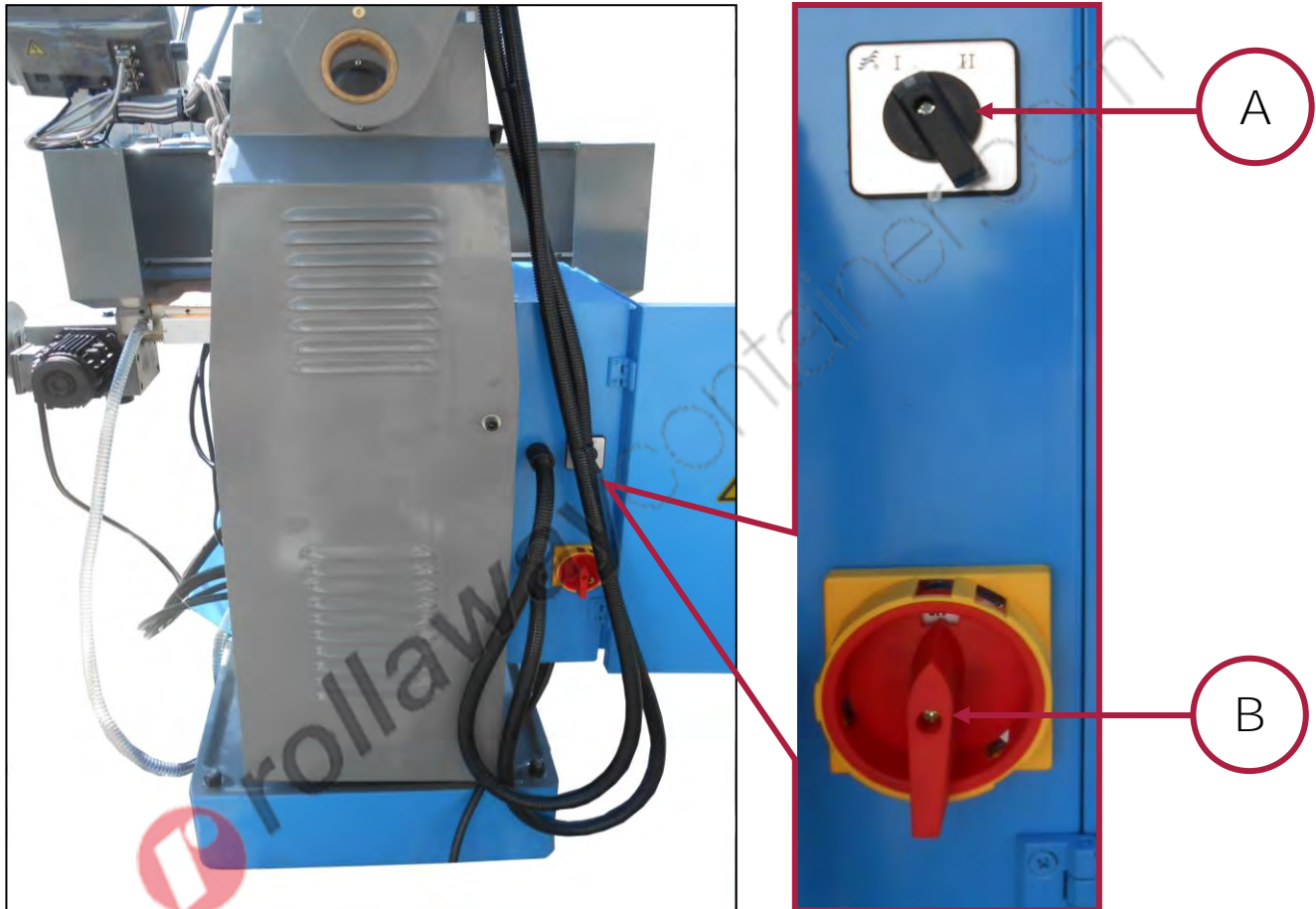
Figura 10 - Sezionatore generale dell'alimentazione elettrica e selettore di velocità.
