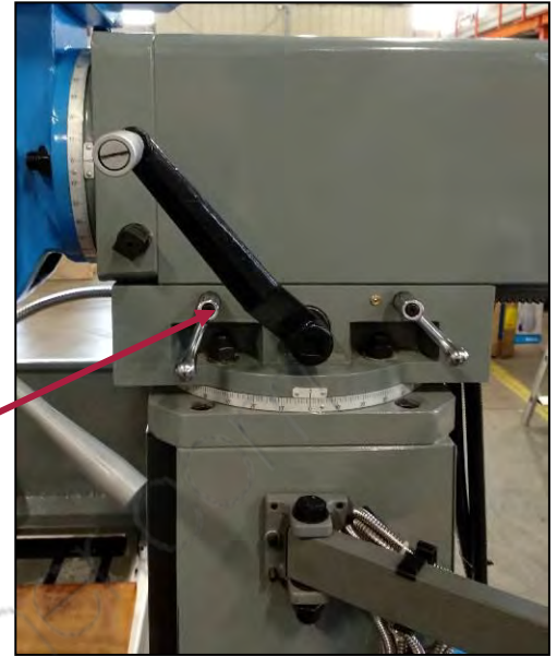
Figura 18 - Leva per la movimentazione radiale della testa.
