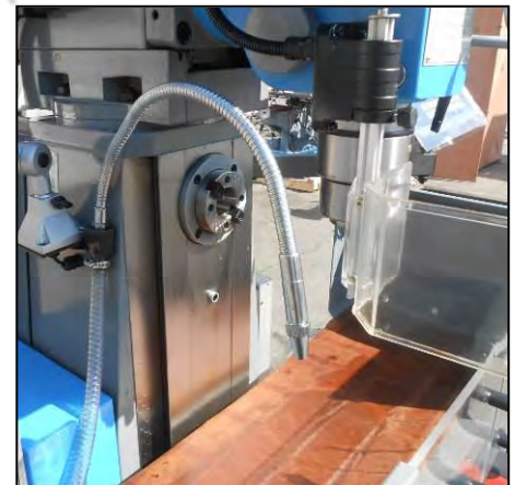
Figura 24 - Rubinetto di uscita del fluido refrigerante.
