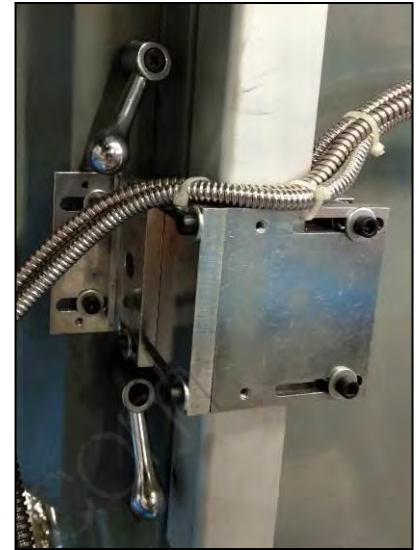
Figura 35 – Leve di bloccaggio della movimentazione verticale della tavola.
