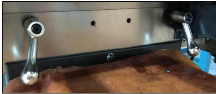
Figura 38 – Leve di bloccaggio della movimentazione longitudinale della tavola.
