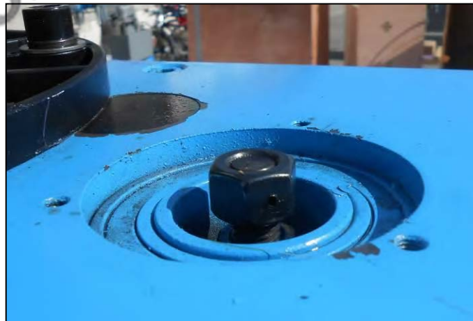
Figura 31 –Barra filettata di collegamento cono mandrino.
