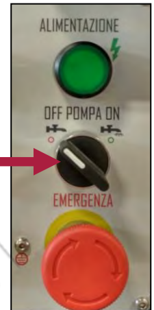
Figura 20 - Selettore per l'attivazione della pompa di aspirazione del liquido refrigerante.
