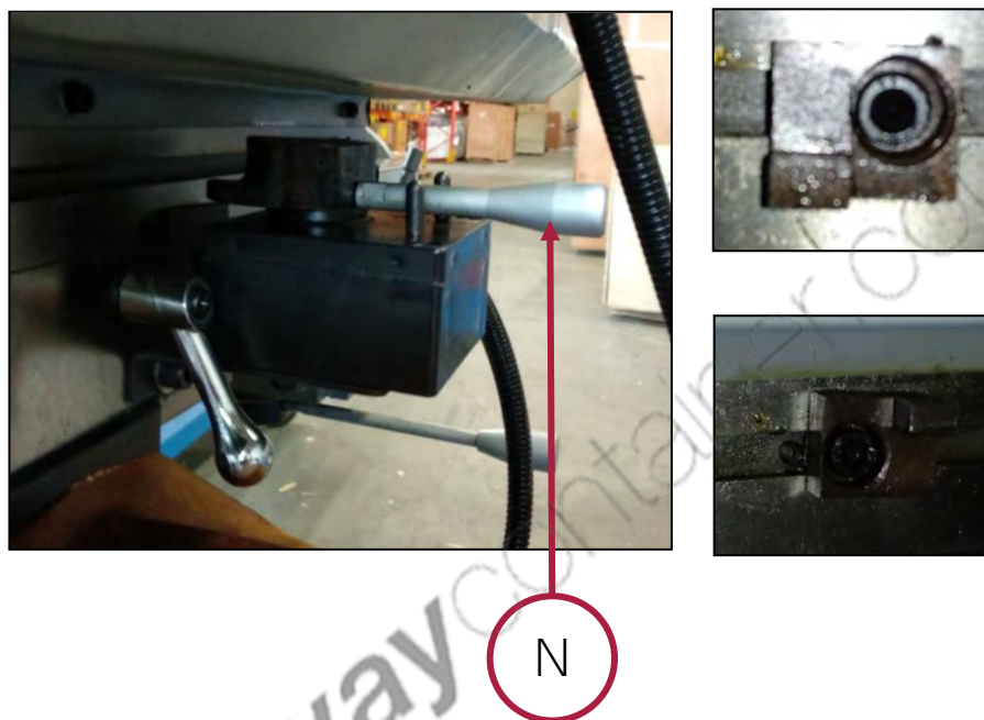
Figura 24 – Leva di azionamento dell'avanzamento longitudinale automatico della tavola e finecorsa di sicurezza.
