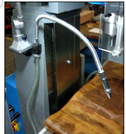
Figura 21 - Rubinetto di uscita del fluido refrigerante.
