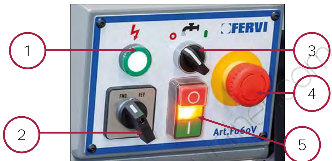
Figura 5 – Quadro di comando della macchina.
