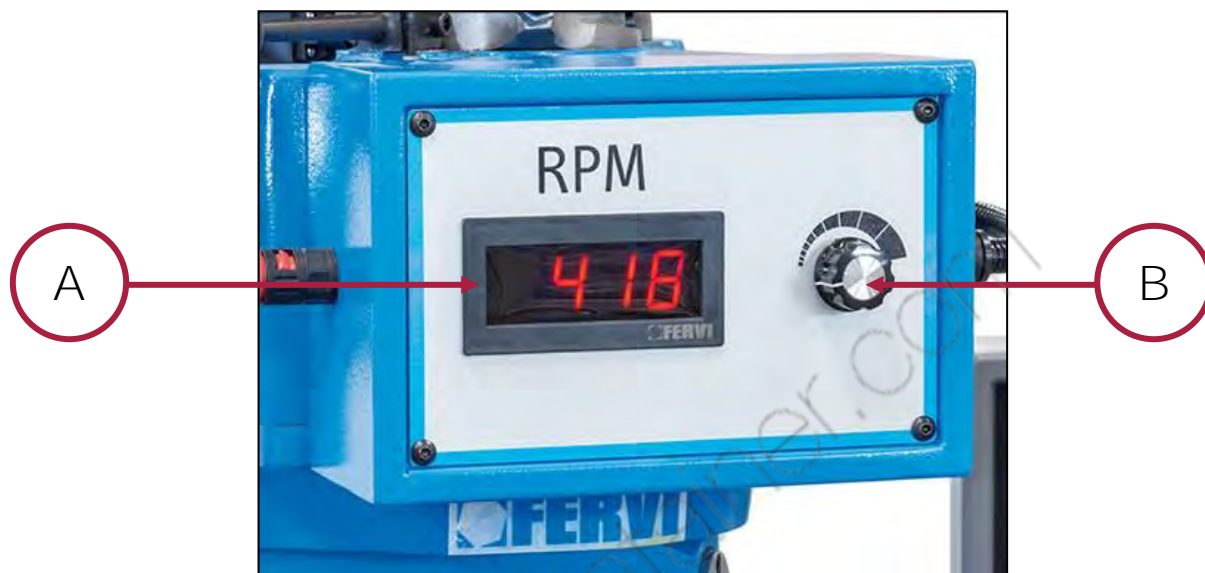
Figura 6 – Quadro di comando velocità mandrino
