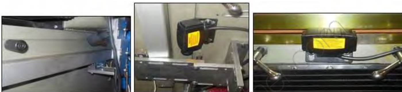
Figura 23 – Finecorsa della tavola portapezzo
