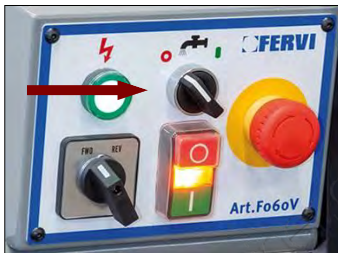
Figura 20 - Selettore per l'attivazione della pompa di aspirazione del liquido refrigerante.
