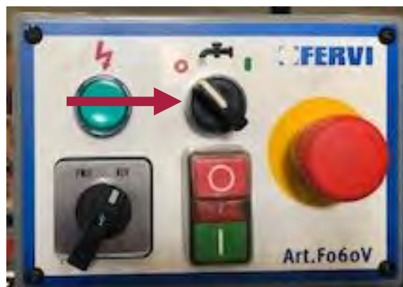
Figura 21 - Selettore per l'attivazione della pompa di aspirazione del liquido refrigerante.
