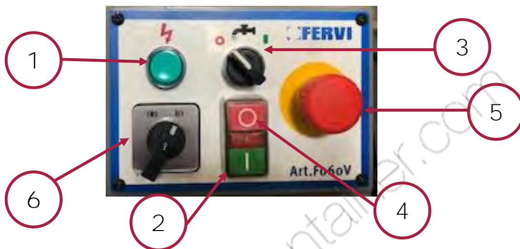
Figura 6 – Quadro di comando della macchina.
