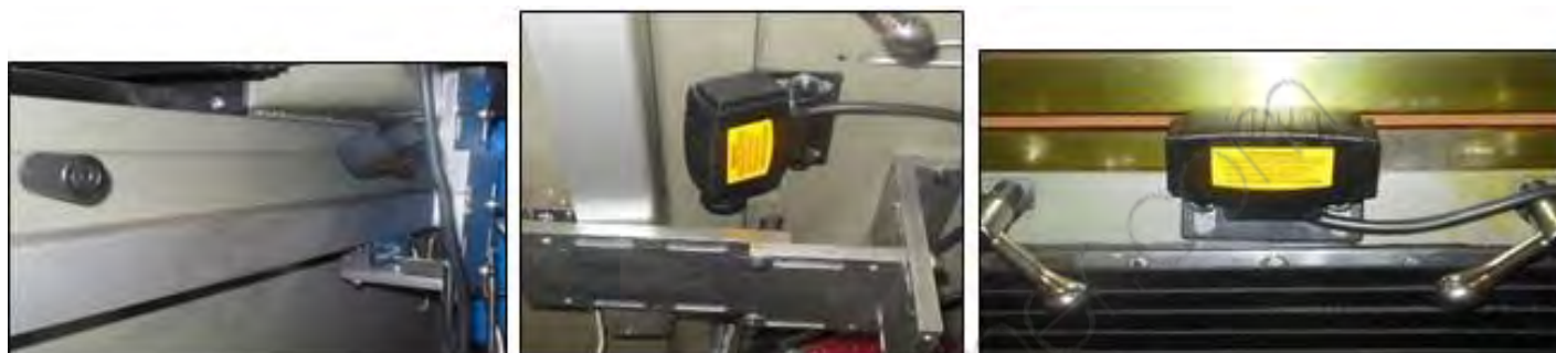
Figura 24 – Finecorsa della tavola portapezzo
