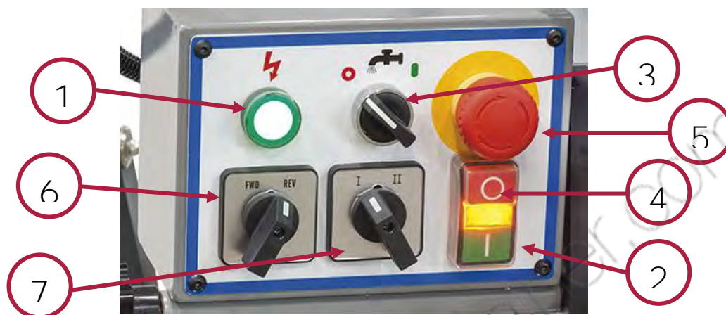
Figura 6 – Quadro di comando della macchina.
