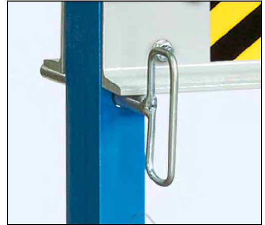
Figura 13 – Inserimento dei perni di sostegno.
