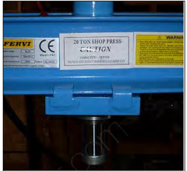
Figura 10 – Montaggio della piastra.
