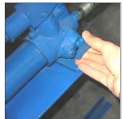
Figura 21 – Valvola di scarico.
