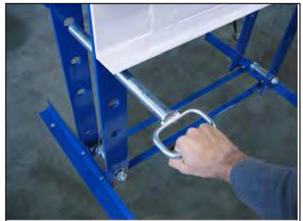
Figura 16 – Estrazione del perno di supporto.
