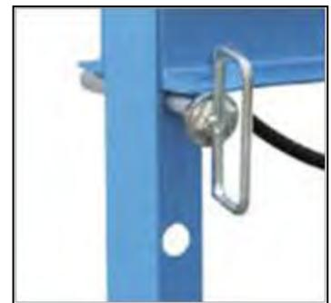
Figura 5 - Perna di bloccaggio del bancale.
