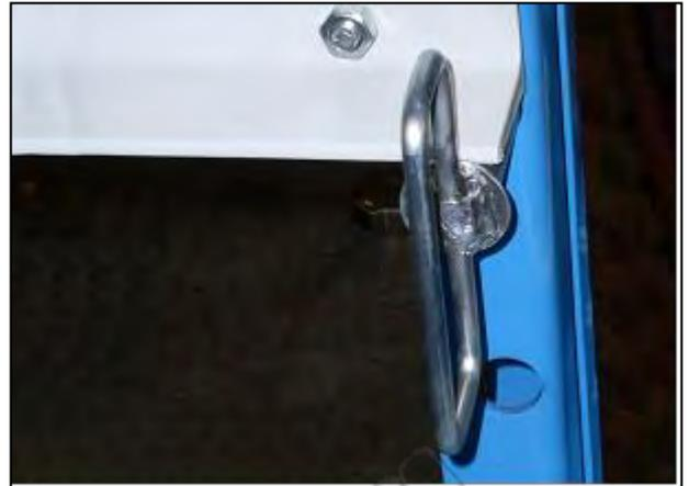
Figura 13 – Inserimento dei perni di sostegno.
