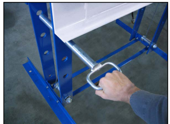
Figura 12 – Estrazione perno di supporto bancale.
