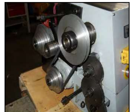
Figura 3- Targa e pulegge della velocità del mandrino.
