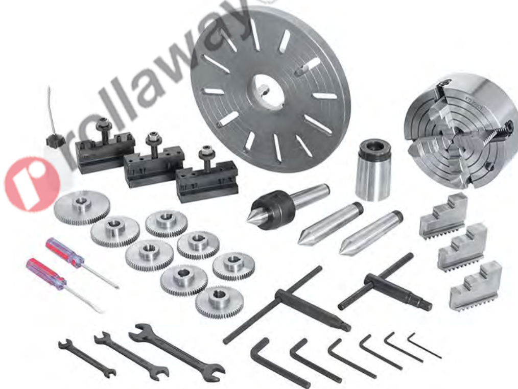
Figura 48 – Accessori forniti con il tornio T070/400V3A.
