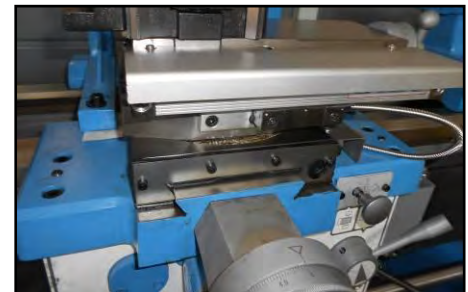
Figura 23 - Viti di rotazione torretta.
