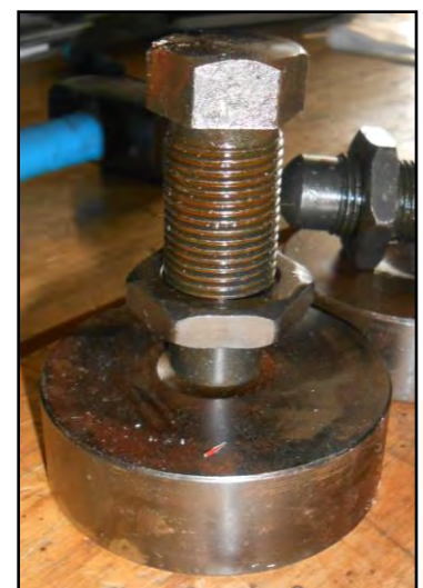
Figura 16 - piedini livellanti macchina.
