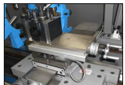
Figura 27 - Viti di rotazione torretta.
