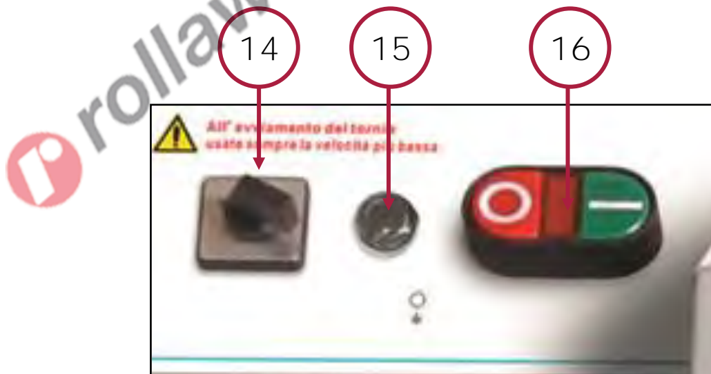
Figura 22 – Quadro elettrico e di comando.
