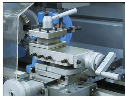
Figura 27 – Posizionamento dell'utensile.
