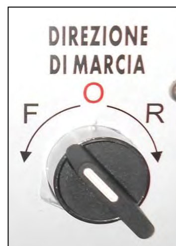
Figura 7 – Selettore verso di rotazione del mandrino.
