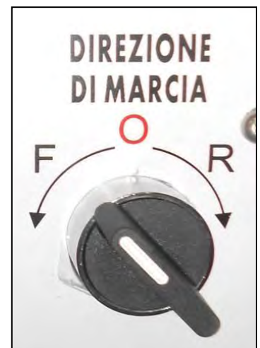
Figura 7 – Selettore verso di rotazione del mandrino.
