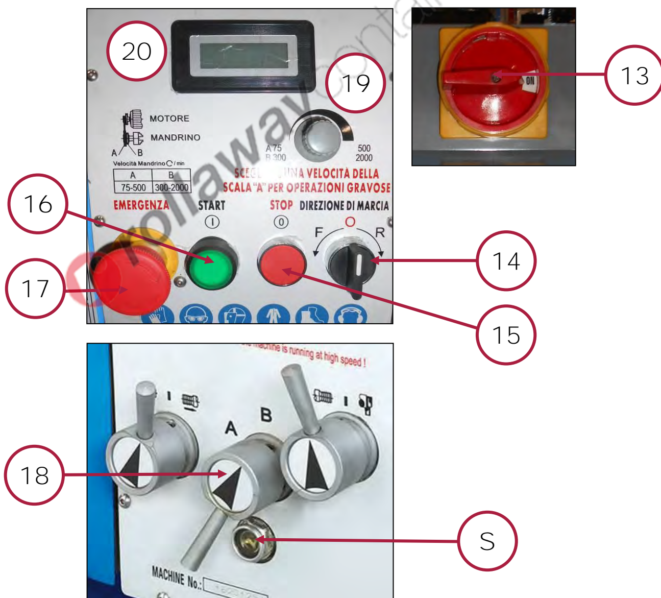
Figura 14 - Quadro di comando.
