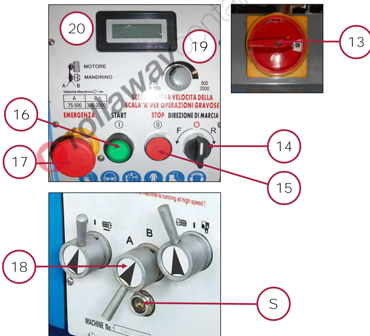
Figura 14 - Quadro di comando.
