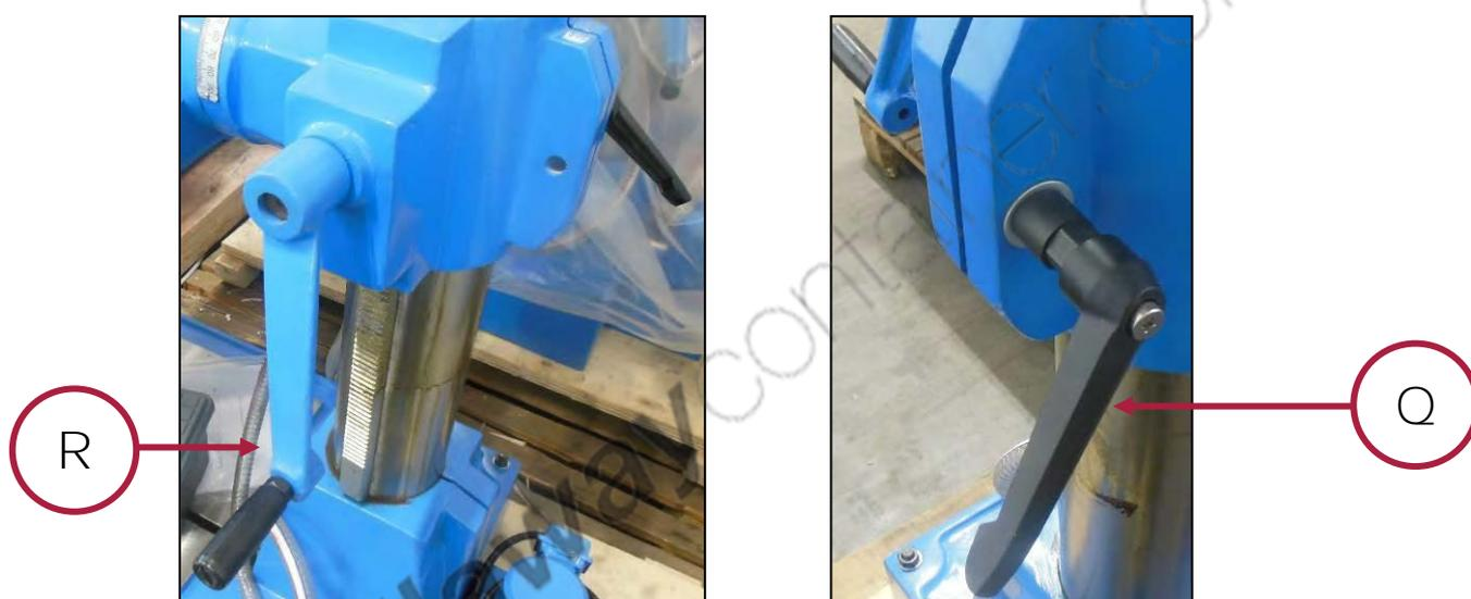
Figura 15 – Manovella regolazione tavola e leve di bloccaggio.
