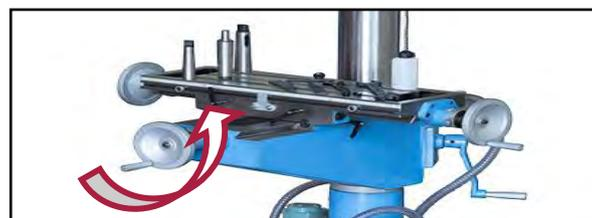
Figura 18 – Volantino avanzamento trasversale
