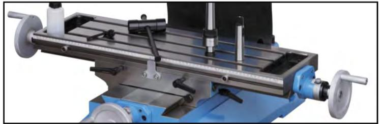
Figura 6 – Volantino avanzamento calibrato longitudinale.
