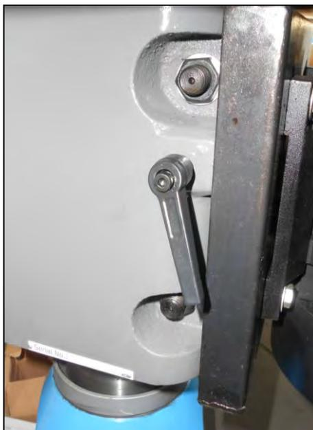
Figura 25 – Manopola blocco motore
