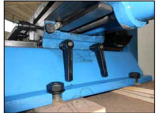
Figura 10 – Leve bloccaggio direzione trasversale.
