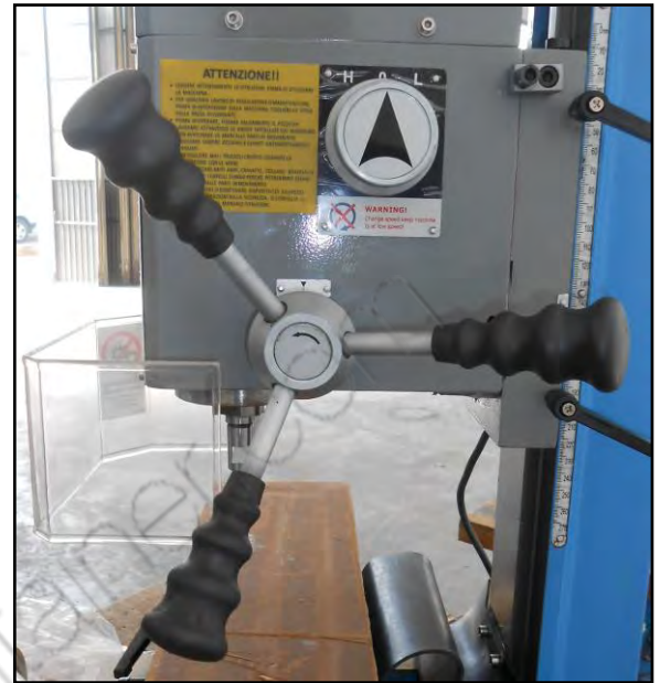
Figura 5 – Raggiera per l'avanzamento verticale rapido del mandrino.
