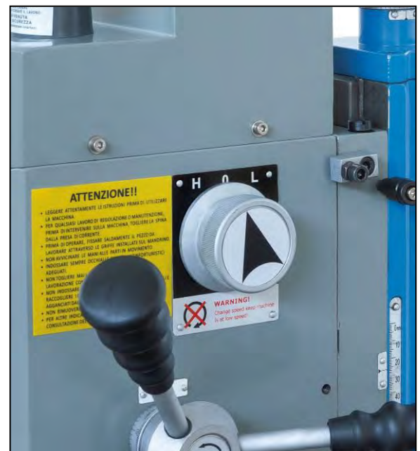
Figura 6 – Ghiera di selezione intervallo di velocità del mandrino.
