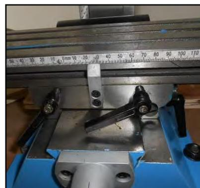
Figura 12 – Leve bloccaggio direzione longitudinale.
