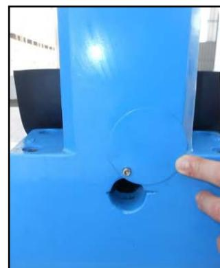
Figura 31 - Oblò di ispezione vite senza fine verticale.
