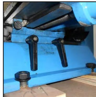
Figura 10 – Leve bloccaggio direzione longitudinale.
