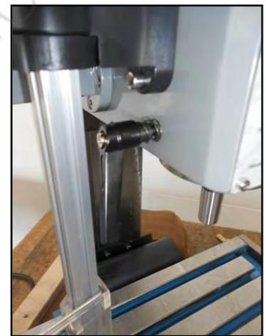
Figura 14 - Leva di bloccaggio avanzamento rapido del canotto.
