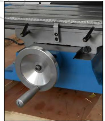
Figura 8 – Volantino avanzamento trasversale.
