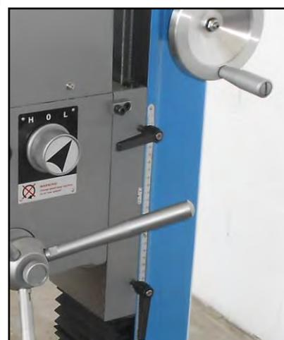
Figura 11 – Leve bloccaggio movimentazione verticale testa.
