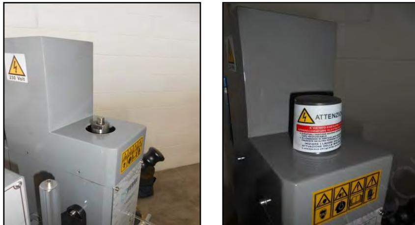
Figura 20 - Tappo di protezione vite di fissaggio mandrino.
