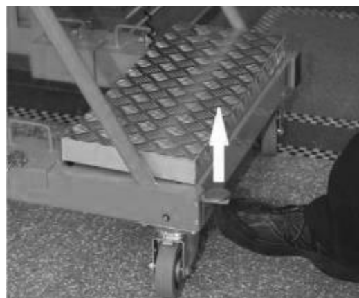
Foto 18 Sblocco ruote Rialzando il pedale sblocchiamo le ruote
